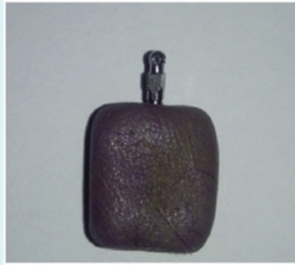
Figure 8 : Éprouvette en résine pour l'insertion des mini-vis. Acrylic resin test tube for the re insertion of the mini-implants.
