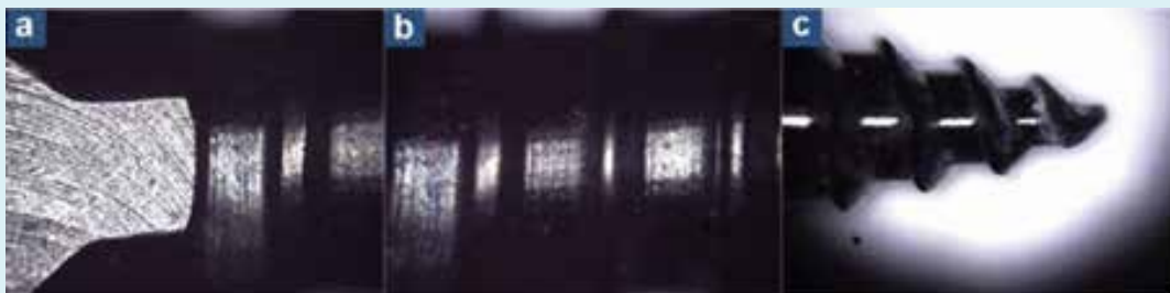
Figure 11 : a-c : illustration à l'échelle 200 \mu\text{m} des différentes sections de la vis : a : col ; b : filetage ; c : pointe autoforante. illustration on a 200 \mu\text{m} scale of the different screw sections: a : neck; b : thread ing; c : self-drilling tip.
