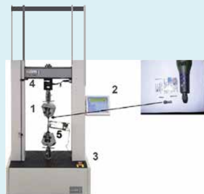
Figure 10 : Équipement Lloyd : 1 : mâchoire ; 2 : ordinateur de traitement de données ; Lloyd equipment: (1) jaw; (2) data processing computer; (3) on/off switch; (4) sensor; (5) strain gauge.
